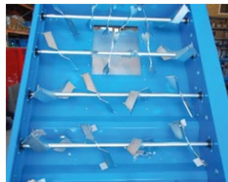
5 ejes de trituración | Exclusa con 5 cámaras – | Turbina de 5 niveles VTG | Chapa de regulación de material electrónica | 4 transformadores de frecuencia | Evacuación de aire de la exclusa
